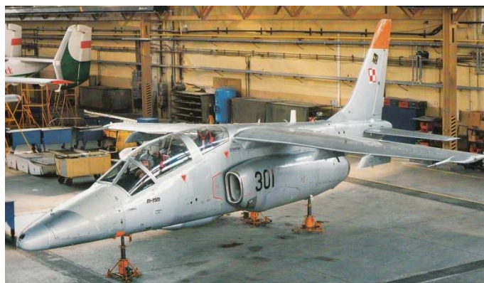
Fot. 69 Samolot PZL M-93 „Iryda” na hali montażowej bez podwozia.
