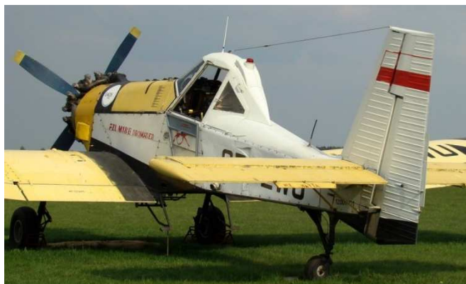
Fot. 57 Samolot M-18B Dromader, z silnikiem 1000 KM służący do celów rolnictwa i gaszenia pożarów. (arch. Wojciech Zaremba)
