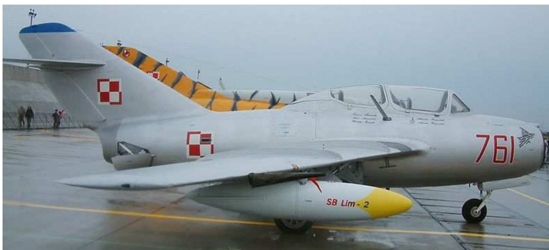
Fot. 39 Samolot MiG-15UTI z podwójną kabiną służący do szkolenia pilotów. Nie był produkowany w Polsce, lecz ZSRR, Czechosłowacji i Chinach. (arch. T. Jakubec)
