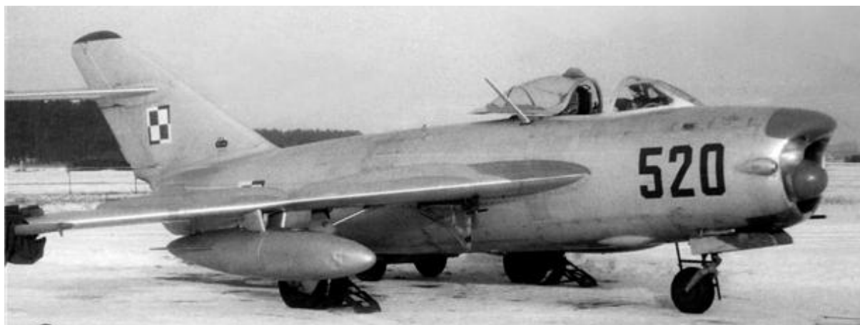
Fot. 41 Samolot Lim 5P licencyjnej wersji MiG 17PF ze stacją radiolokacyjną RP-5 (arch. W Sankowski)
