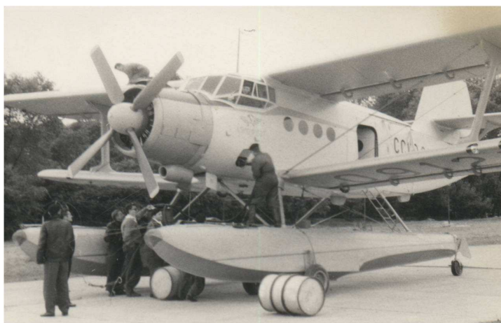
Fot. 52 Samolot AN-2M w wersji morskiej z zamontowanymi pływakami. (arch. T. Lenartowicz)
