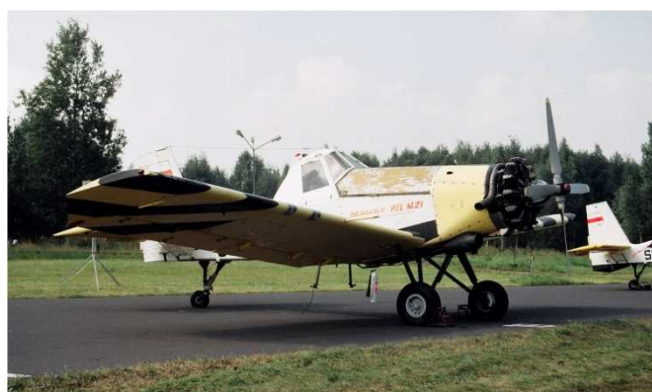
Fot. 59 Samolot M-21 Dromader Mini z mocą silnika 600 KM przeznaczony do prac na mniejszych polach. (arch. Tadeusz Pakuła)
