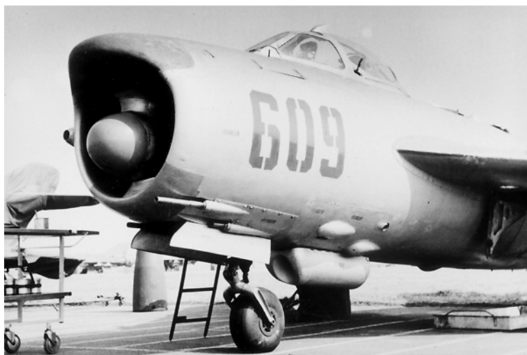
Fot. 42 Przednia część kadłuba samolotu Lim 5P. Pod osłoną w wysuniętej części u góry kadłuba tzw. wardze znajduje się antena szukająca, poniżej w środku wlotu powietrza antena śledząca RP-5. (arch. T. Lenartowicz)
