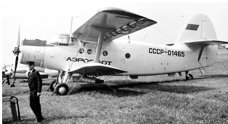
Fot. 50 Samolot AN-2R wersja rolnicza z zamontowanym pod kadłubem rozsiewaczem. (arch. Tadeusz Pakuła)
